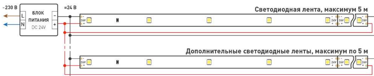
Схема 2. Подключение нескольких светодиодных лент с двух сторон.
