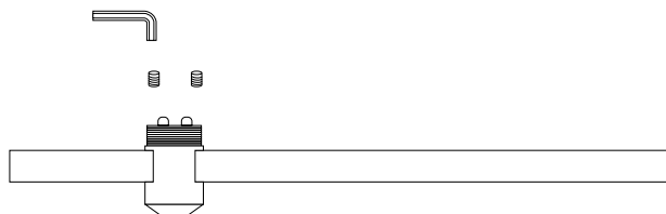
Рис. 2. Установка держателя на трек
