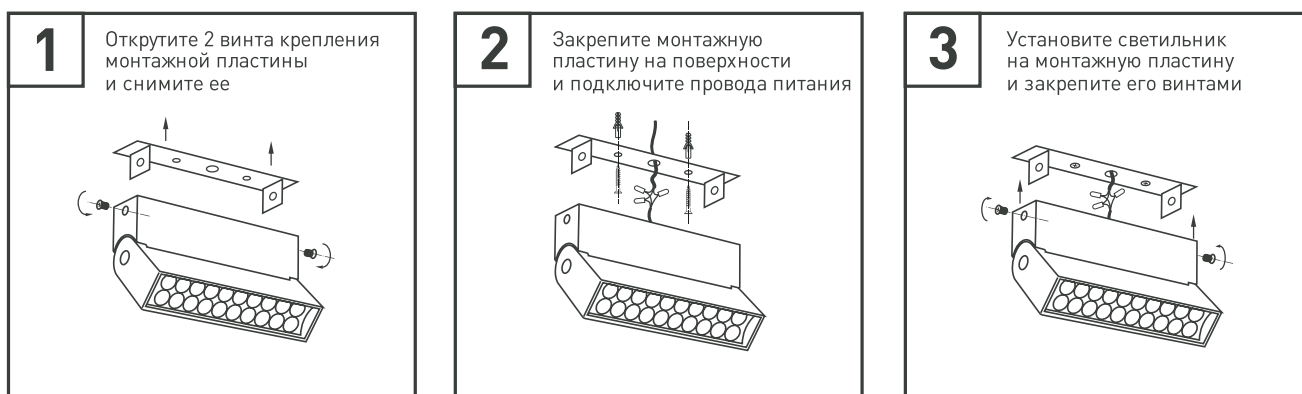
Рис. 2. Установка и подключение светильника
