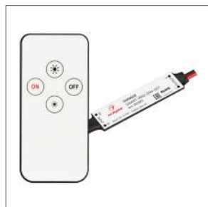
031593 | Диммер SMART-MINI-DIM-SET (12-24V, 1x4A, ПДУ 4кн, IR)
