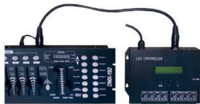
Рис. 4. Подключение DMX-консоли для управления контроллером.
