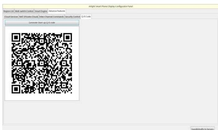
«Generate Start-up QR Code» — сгенерировать QR-код доступа. Данный QR-код позволяет автоматически добавить контроллер в приложение и авторизоваться без ввода логина и пароля.
