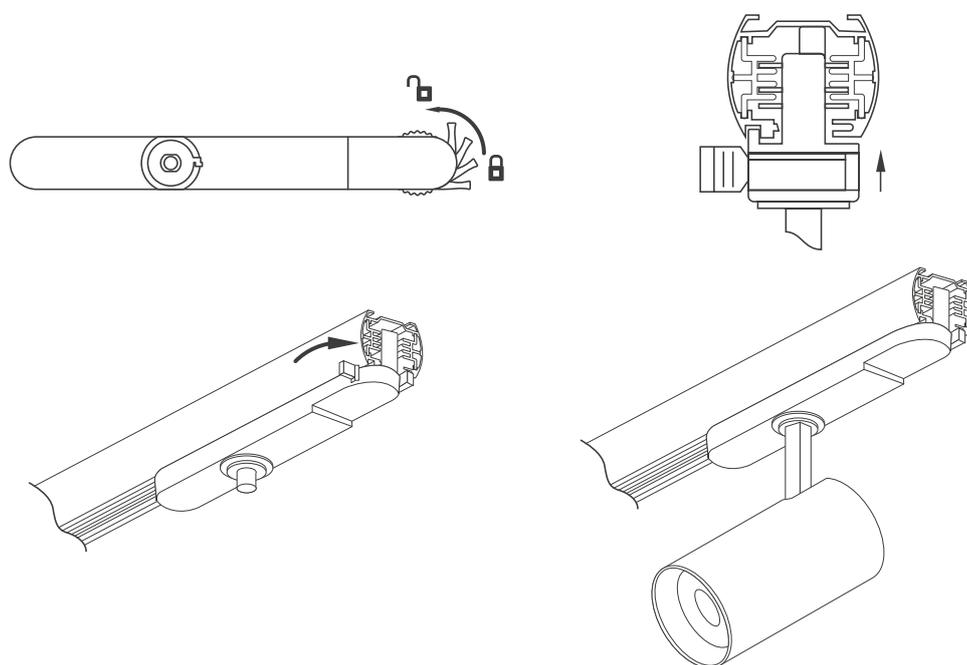
Рис. 2. Установка светильника в трек
