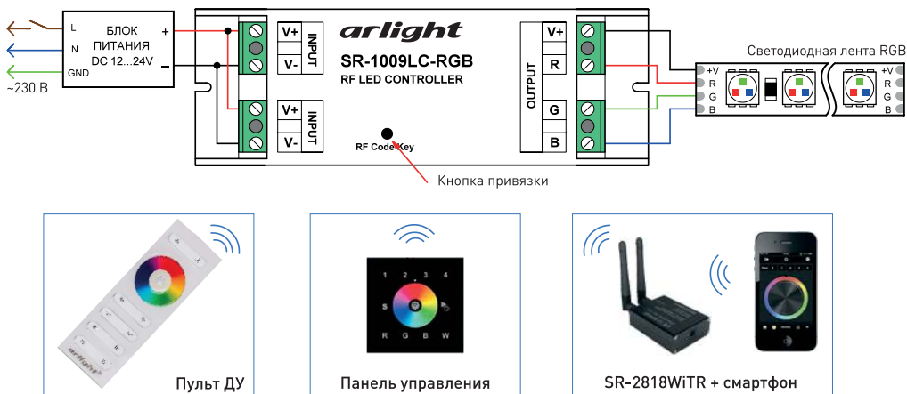
Рис. 2. Схема подключения оборудования на примере контроллера SR-1009LC-RGB.
