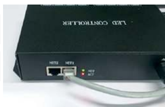
Рис. 2. Подключение контроллера HX-801RC к мастер-контроллеру или компьютеру.
