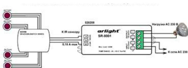
Система на 16 датчиков. Если открывается какая-либо дверь, включается свет.
