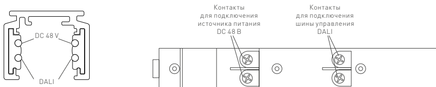
Рис. 5. Расположение контактов на шинопроводе и в коннекторе питания MAG-ORIENT-CON-POWER (пластиковая крышка снята)
