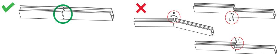
2.9.2. Устанавливайте отрезки профиля без перекосов, которые могут способствовать защемлению «неона» в профиле и его выходу из строя в связи с расширением и сжатием ПВХ-трубы «неона» при высоких и низких температурах.
