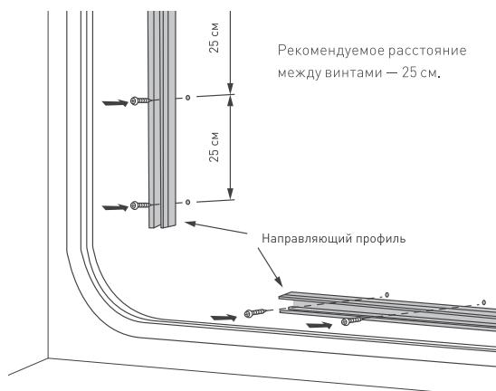
2.9.1. Рекомендуется оставлять технологические зазоры между отрезками профилей при монтаже, чтобы учесть изменения длины профиля при изменении температуры.
