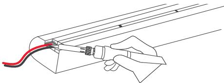
Распайте провод питания [арт. 026349] к контактным площадкам платы, соблюдая полярность подключения. Время пайки не должно превышать 5 секунд при температуре жала паяльника не выше 280 °С. Используйте только нейтральный флюс, после пайки удалите остатки флюса спиртовым растворителем.
