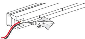
3.4. Припаяйте провода питания к контактным площадкам платы, соблюдая полярность подключения.
