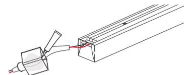
3.5. Нанесите в заглушку с отверстием для провода питания из комплекта достаточное количество  $\frac{1}{3}$  —  $\frac{1}{2}$  внутреннего объема заглушки) нейтрального силиконового герметика (арт. 028100), установите заглушку на неон. При этом провод питания должен проходить через отверстие в заглушке. Удалите излишки герметика.
