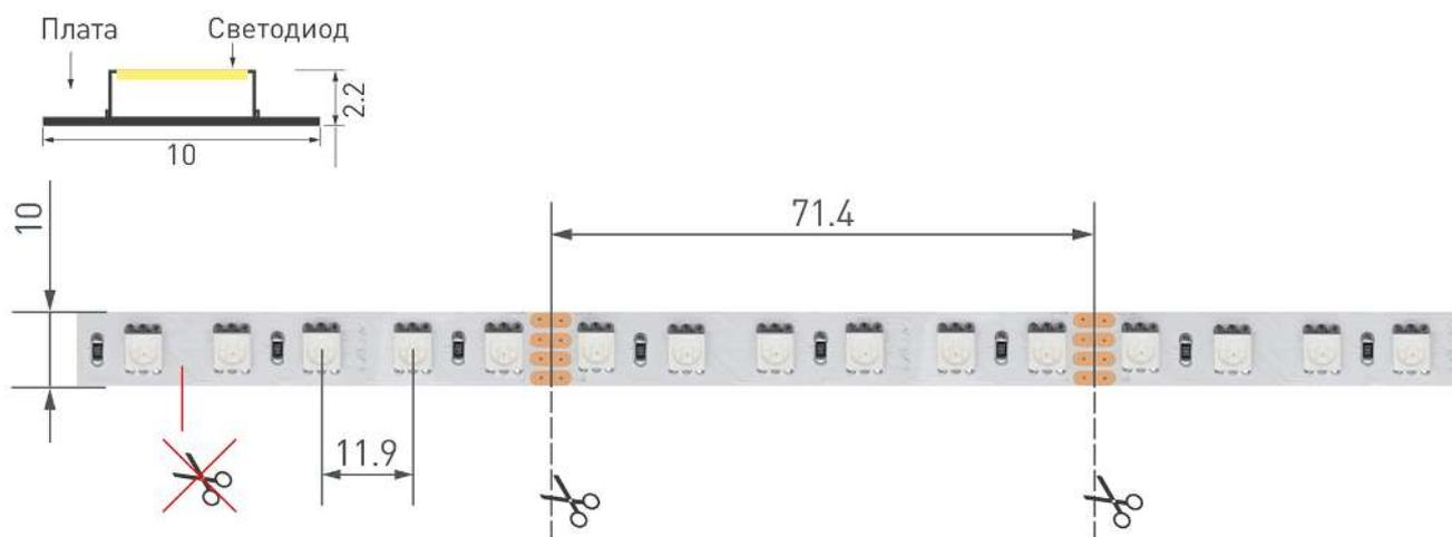
Не допускается разрезать ленту в необозначенном месте.
