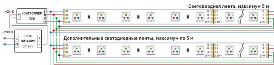
Черный провод - общий «+», красный провод - «R», зеленый провод - «G», синий провод - «B»
