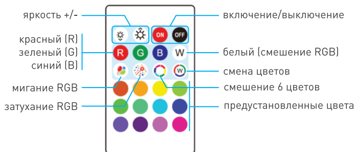
Рисунок 2. Назначение кнопок на пульте SMART-MINI-RGB-SET
