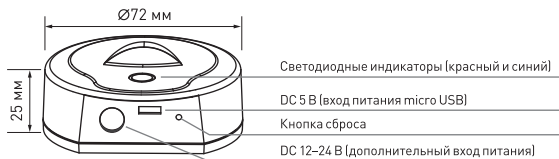
Рис. 1. Назначение индикаторов и кнопок на корпусе конвертера
