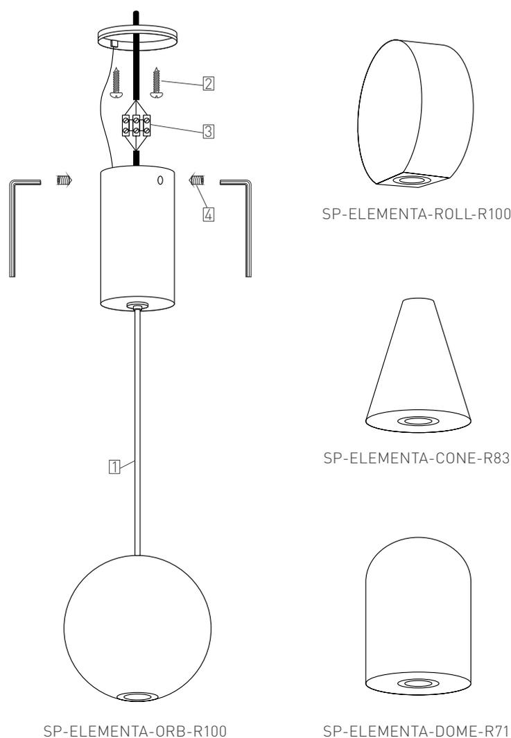
Рис. 1. Установка и подключение светильника
