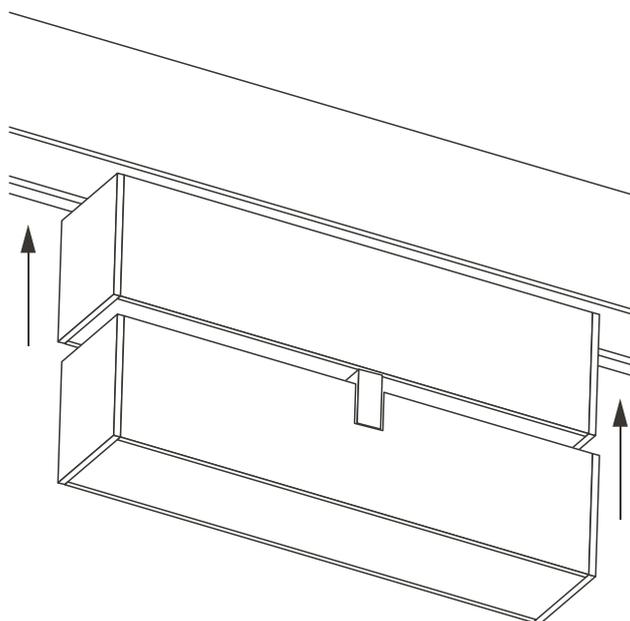
Рис. 2. Установка светильника
