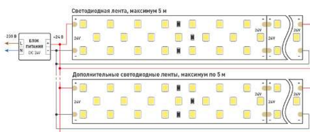
Схема 2. Подключение нескольких светодиодных лент с двух сторон.
