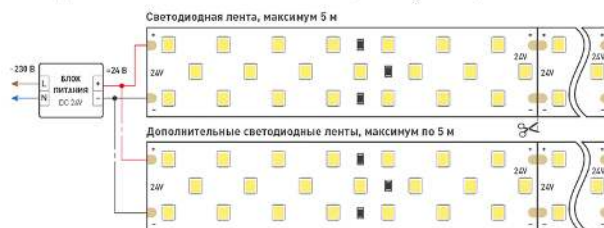
Схема 1. Подключение нескольких светодиодных лент с одной стороны.
