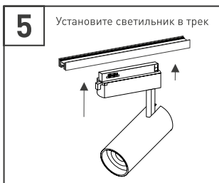
Рис. 2. Установка и подключение светильника
