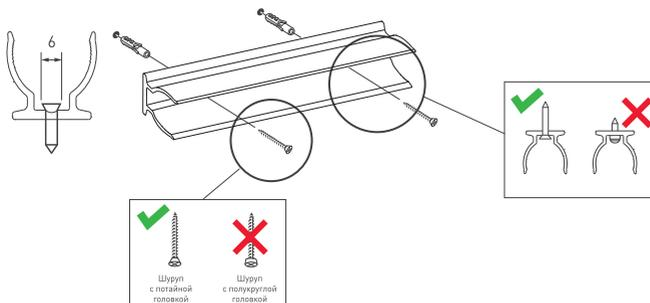
Выбирайте крепеж согласно рекомендациям. Диаметр крепежного отверстия — 3.5 мм. Максимальный диаметр головки шурупа — 6 мм. Используйте шурупы с потайной головкой.
