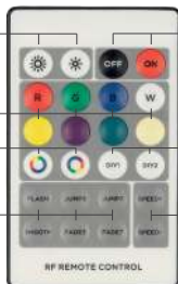
Рисунок 3. Назначение кнопок на пульте ARL-4022-RGBW White
