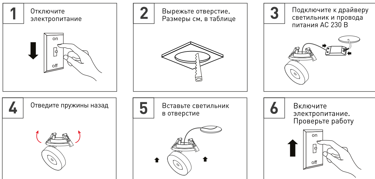
Рис. 2. Установка и подключение светильника
