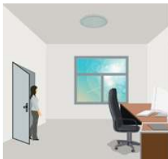
При достаточном естественном освещении светильник не включается при обнаружении присутствия человека.
