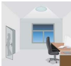
По истечении времени ожидания свет приглушается, если уровень естественного освещения окружающей среды в режиме ожидания ниже порога дневного света.
