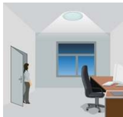
При недостаточном естественном освещении светильник автоматически включается при обнаружении присутствия человека.
