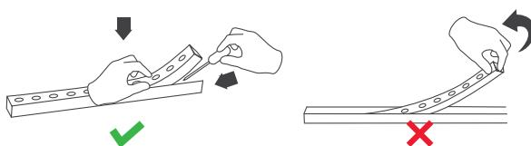
Для демонтажа ленты используйте инструмент (отвертку с плоским лезвием).
