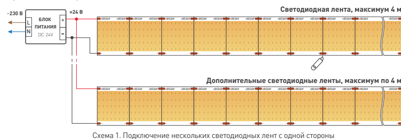
Схема 1. Подключение нескольких светодиодных лент с одной стороны
