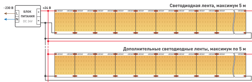
Схема 2. Подключение нескольких светодиодных лент с двух сторон для обеспечения равномерного свечения ленты по всей длине
