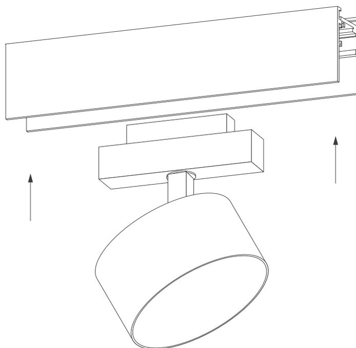
Рис. 2. Установка светильника
