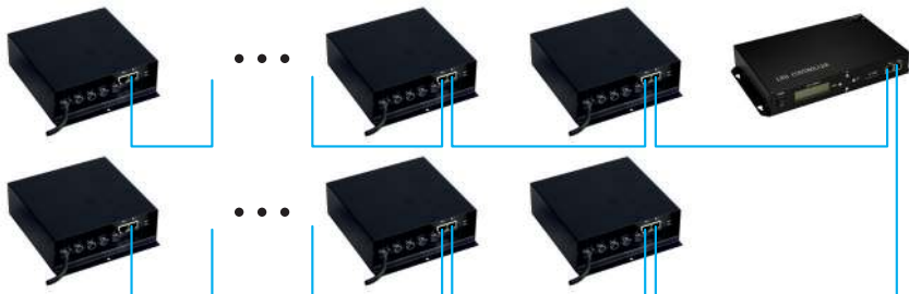
Рис 2. Slave-контроллеры подключаются к двум портам Master-контроллера.
