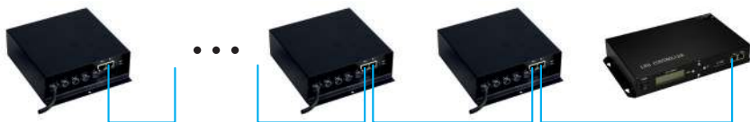
Рис 1. Все Slave-контроллеры подключаются к одному порту Master-контроллера.
