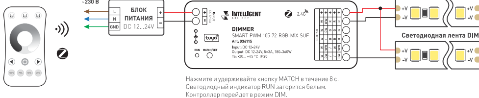
Рис. 1. Схемы подключения диммера SMART-PWM-105-72-RGB-MIX-SUF
