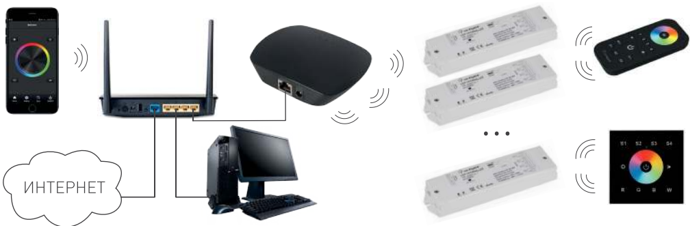
Рисунок 3. Подключение через роутер с использованием проводного соединения.
