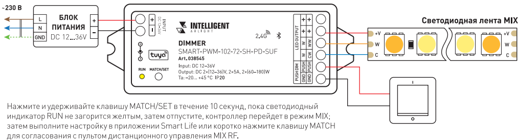
Рис. 2. Подключение MIX-ленты
